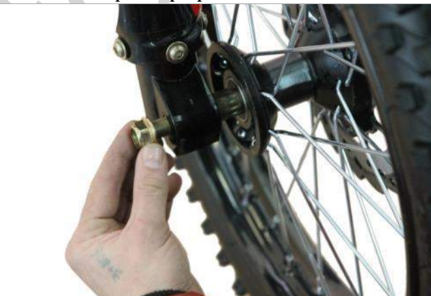
3.5.8. Вставьте осевой болт через втулку в правую вилку амортизатора и накрутите гайку.
