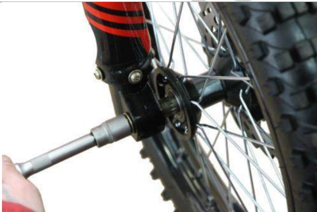
3.5.9. Затяните осевой болт.
