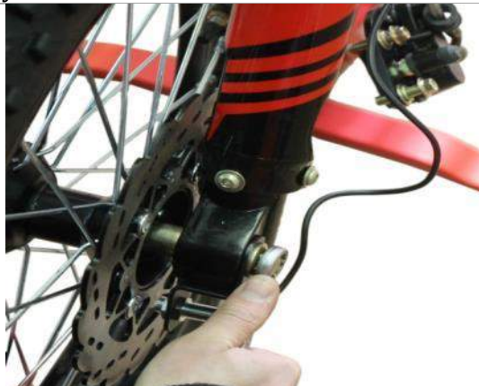
3.5.8. Вставьте осевой болт через втулку в правую вилку амортизатора и накрутите гайку.
