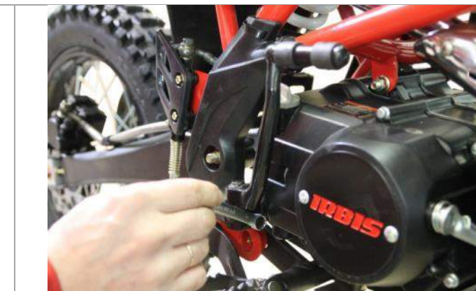
3.12.2 Затяните болт накидным ключом.
