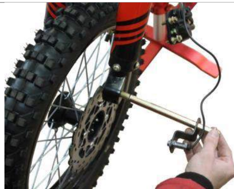
3.5.4. Далее проденьте ось через левую вилку амортизатора.
