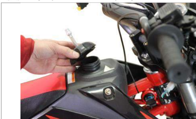
3.11.1. Установите крышку бензобака, как показано на фотографии.
