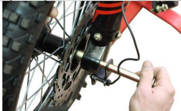
3.5.6. Вставьте осевой болт через втулку, как показано на фотографии.
